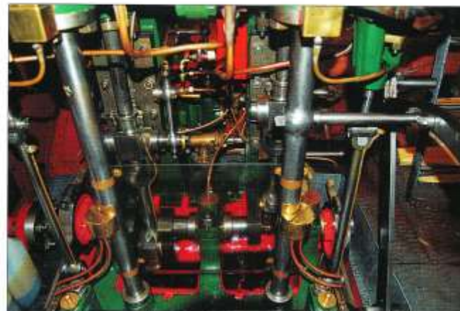
Ångmaskinen i HERBERT är tillverkad av Ljunggrens Mek Verkstad i Kristianstad. Det är en tvåcylindrig compoundmaskin på 45 indikerade hästkrafter försedd med Hackworths slidstyrning. Foto Bo Starmark
